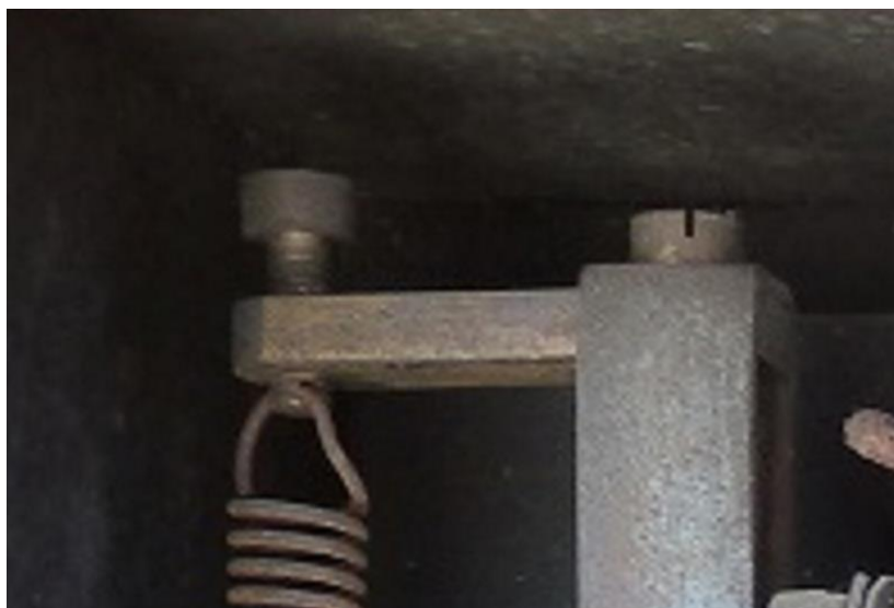
Fig. 3 Fabrieksinstelling veerspanning boveninstelling
