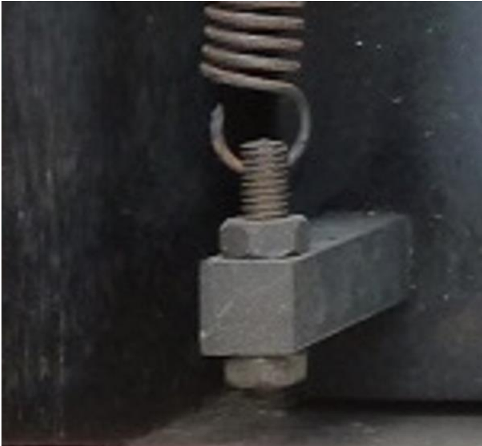
Fig. 4 Fabrieksinstelling veerspanning onderinstelling
